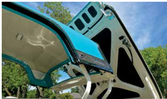
Механизм складывания жёсткой крыши, разработанный Конрадом Джобстом
