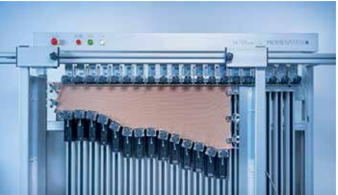
Рис. 10. HOSY — система Hohenstein для тестирования действия медицинского компрессионного трикотажа. Источник https://www.hbm.com/en/7556/hohenstein/
