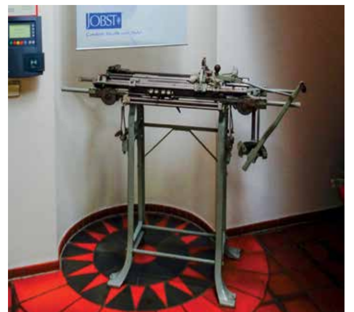
Старый станок для производства компрессионного трикотажа плоской вязки на фабрике Jobst Эммерих (Германия)
